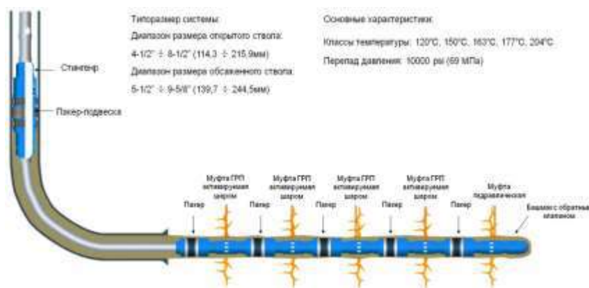
Рисунок 1 — Схема многостадийного гидроразрыва пласта (МГРП) в низкопроницаемом коллекторе
